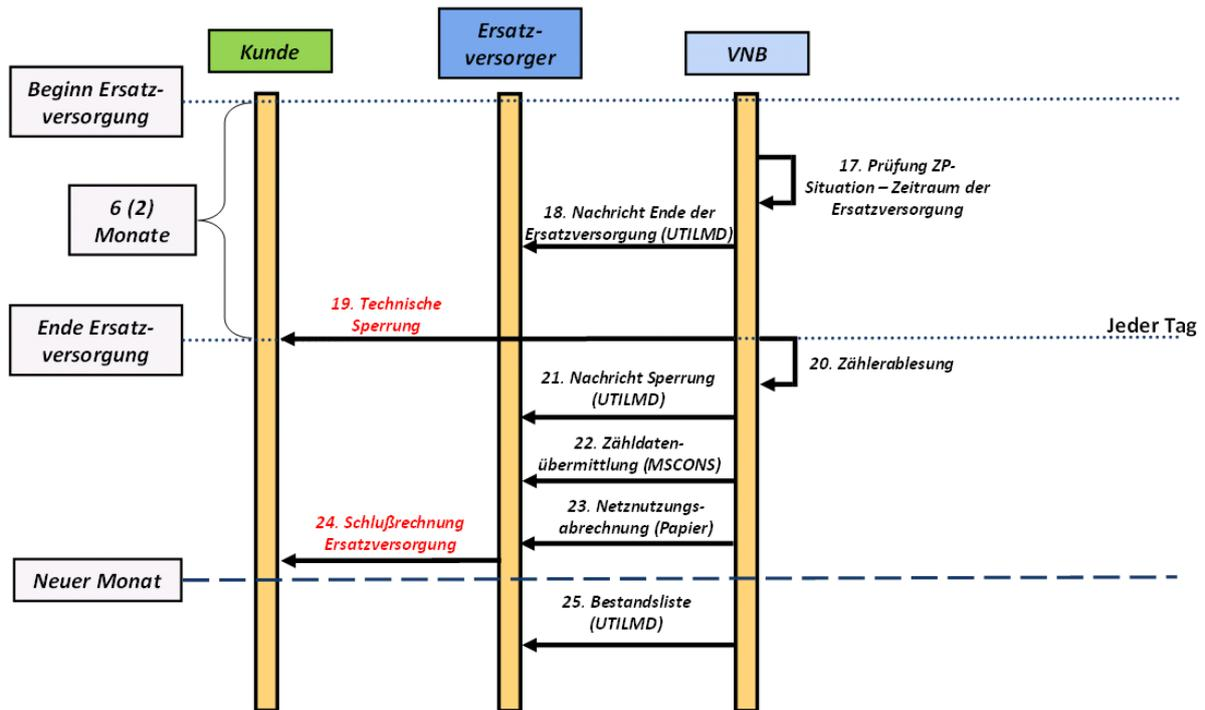
Abbildung 2.8.1: Sequenzdiagramm Ende der Ersatzversorgung
