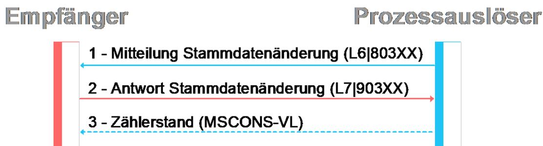
Abbildung 2.10.1: Sequenzdiagramm Stammdatenänderung
