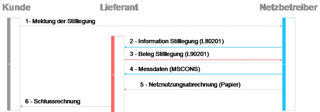
Abbildung 2.4.1: Sequenzdiagramm Lieferende durch Netzbetreiber
