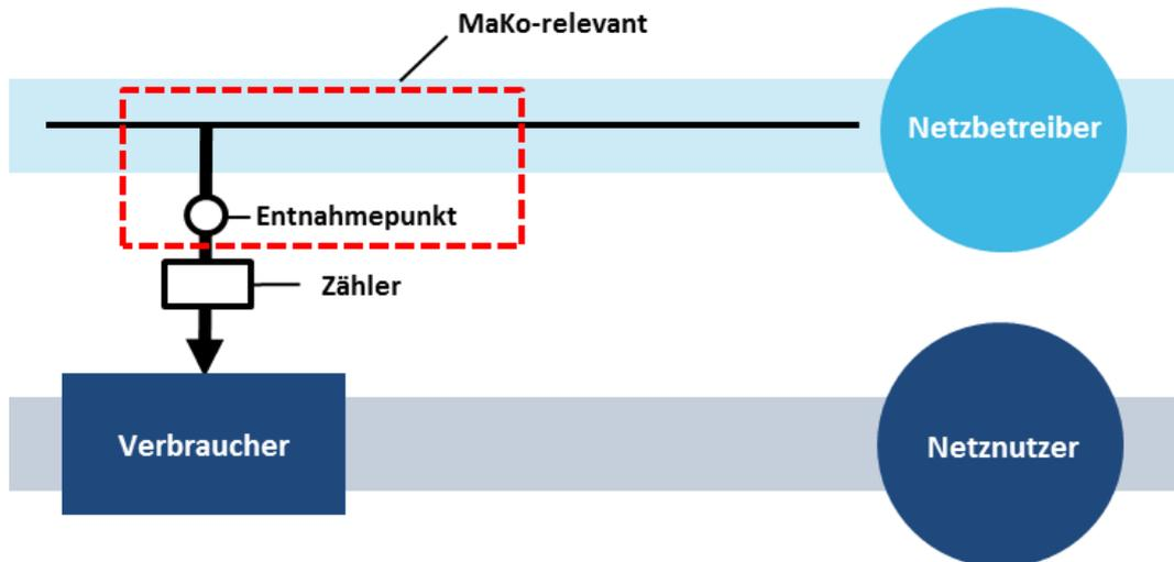
Abbildung 1.4.1: Modell einfache Stromentnahme
