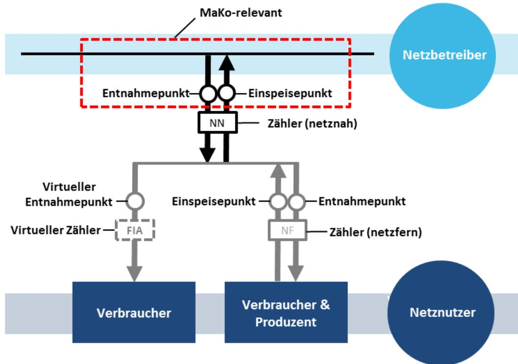
Abbildung 1.4.3: Modell Stromerzeugung zum Eigenverbrauch
