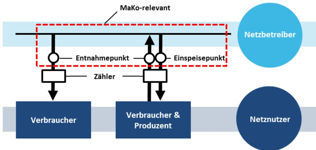
Abbildung 1.4.2: Modell Stromentnahme mit Einspeisung
