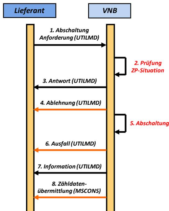
Abbildung 2.15.1: Sequenzdiagramm Smartabschaltung
