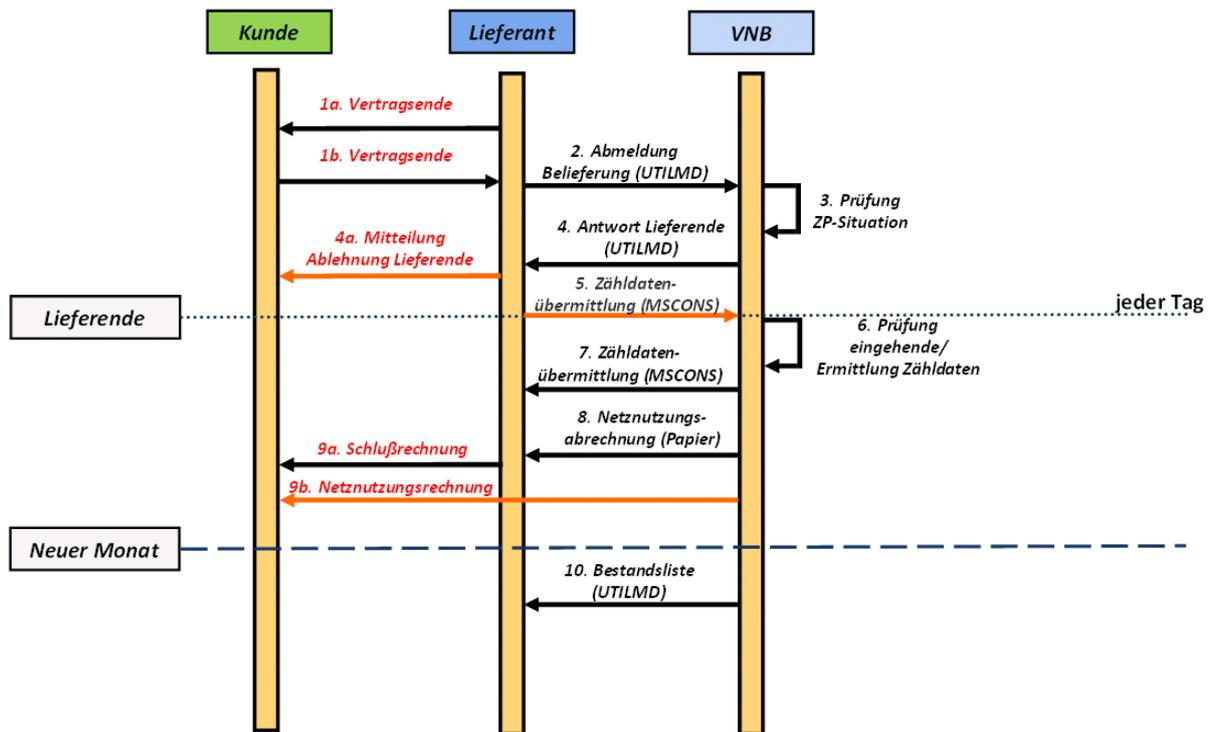
Abbildung 2.9.1: Sequenzdiagramm Zählerablesung und Messdatenübermittlung
