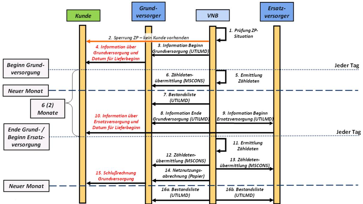
Abbildung 2.5.1: Sequenzdiagramm Beginn der Grundversorgung
