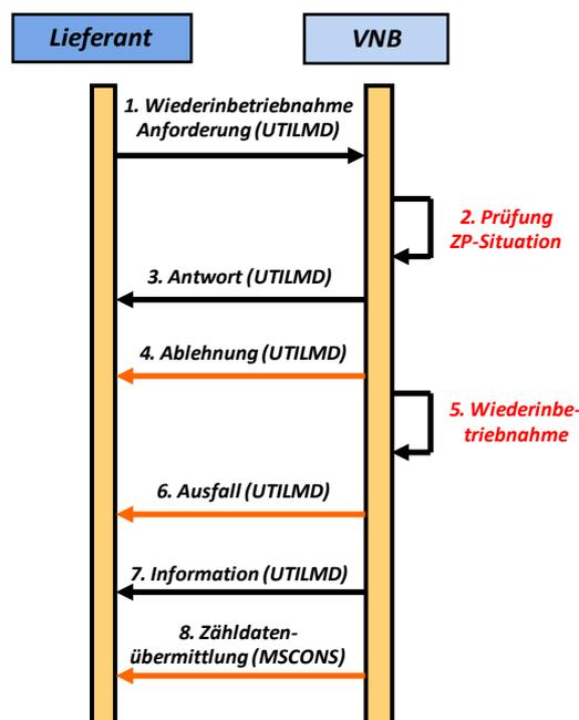
Abbildung 2.16.1: Sequenzdiagramm Smartwiederinbetriebnahme
