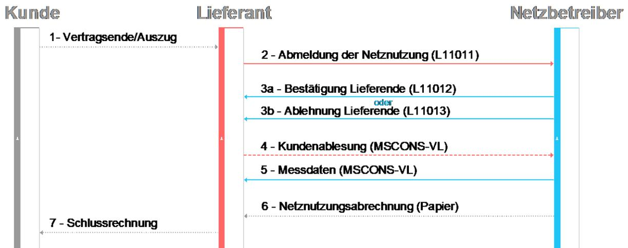
Abbildung 2.3.1: Sequenzdiagramm Lieferende durch Lieferant
